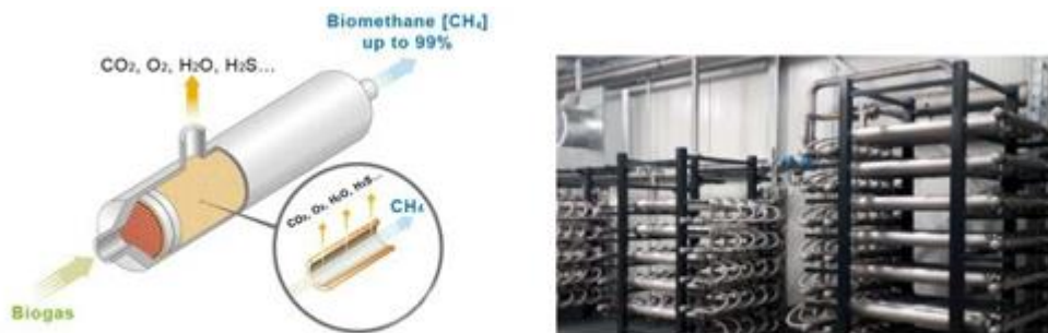
Att. Biogāzes attīrīšanas shēma ar membrānām un foto ar membrānu iekārtu.
