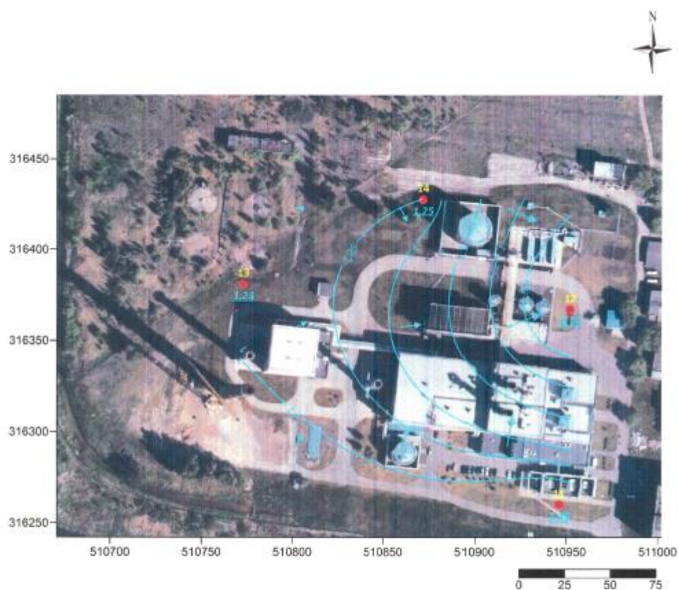
Novērošanas aku izvietojuma un izohipsu shēma TEC-1 teritorijā
